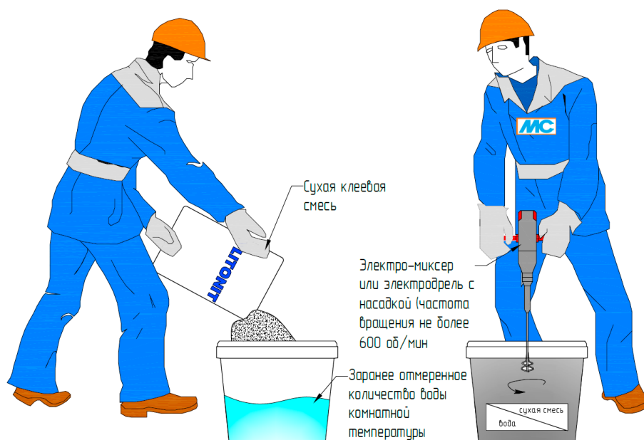
Рис. 35. Организация работ по затворению сухой клеевой смеси
