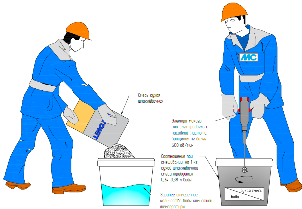
Рис. 31. Организация работ по затворению сухой шпаклевочной смеси
